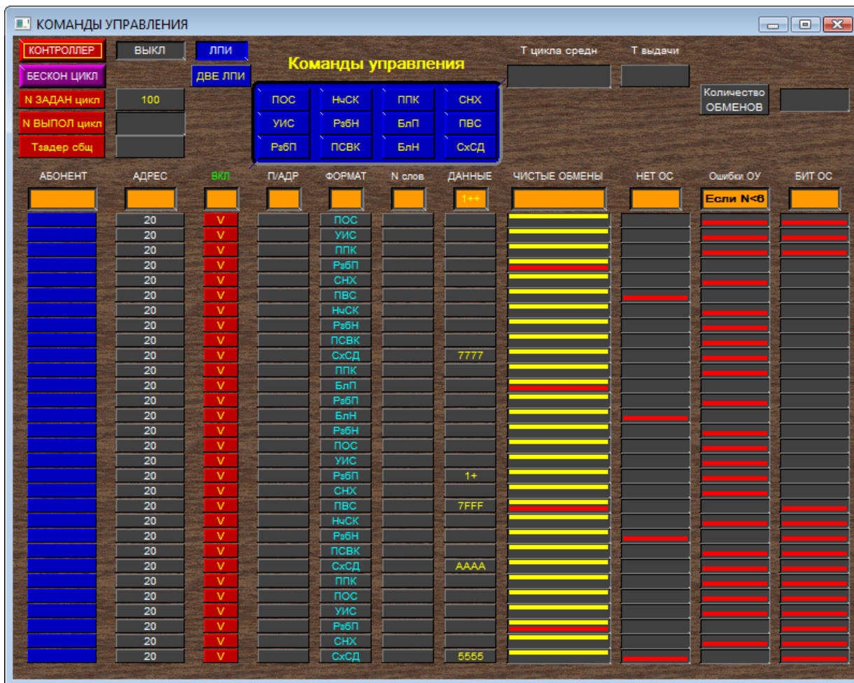
Рис.26 Пример тестирования ОУ на выполнение команд управления
