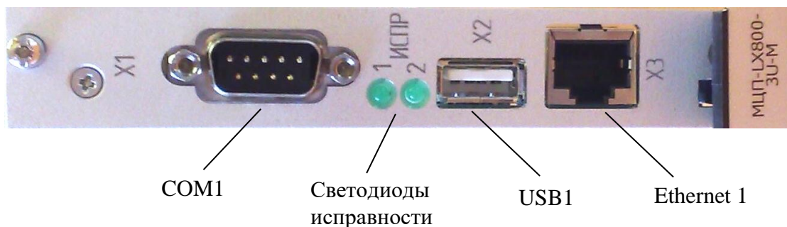
Рисунок 5 Расположение разъемов и светодиодов на передней панели
